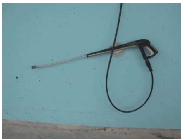
Nettoyeur haute pression pour une aire de lavage - Photo IFV
